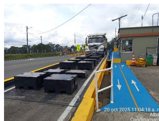
Foto 112: Verificación básculas por parte del OAVM.
