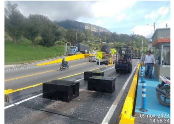
Foto 152: Verificación básculas por parte del OAVM
